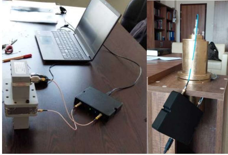
Şekil 3.5. Koaksiyel iletim hattı yöntemi ölçüm düzeneği a. Genel Düzen b. Ölçüm Aparatı
