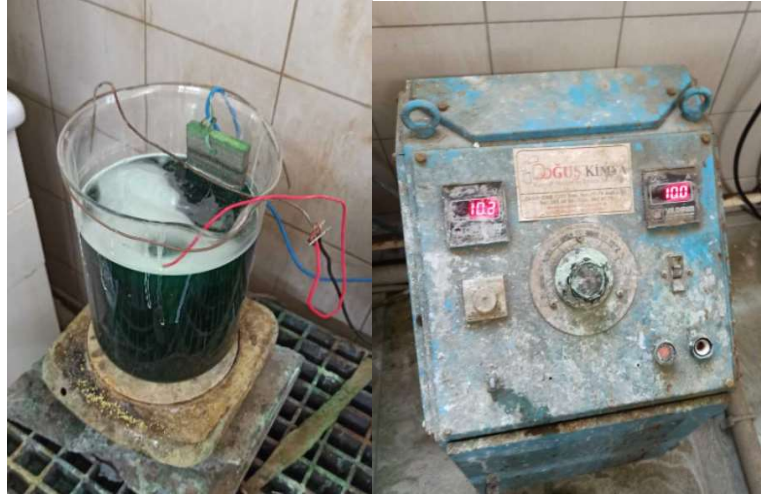
Şekil 3.2. a. Elektro Kaplama Banyosu b. Güç kaynağı
