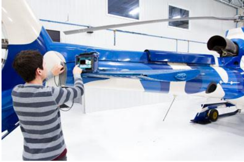
Şekil 27 Hava aracı üzerinde gerçekleştirilen C-Scan örneği
