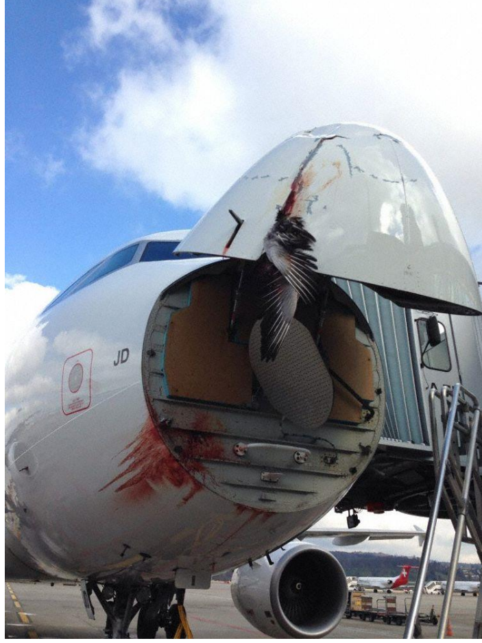
Şekil 1.1 Kuş Çarpması A320-200
