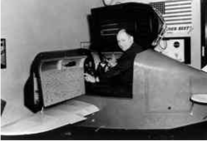
Şekil 2: 1929 yılında Edward Link'in tasarladığı kabin simülatorü "Penguin"
