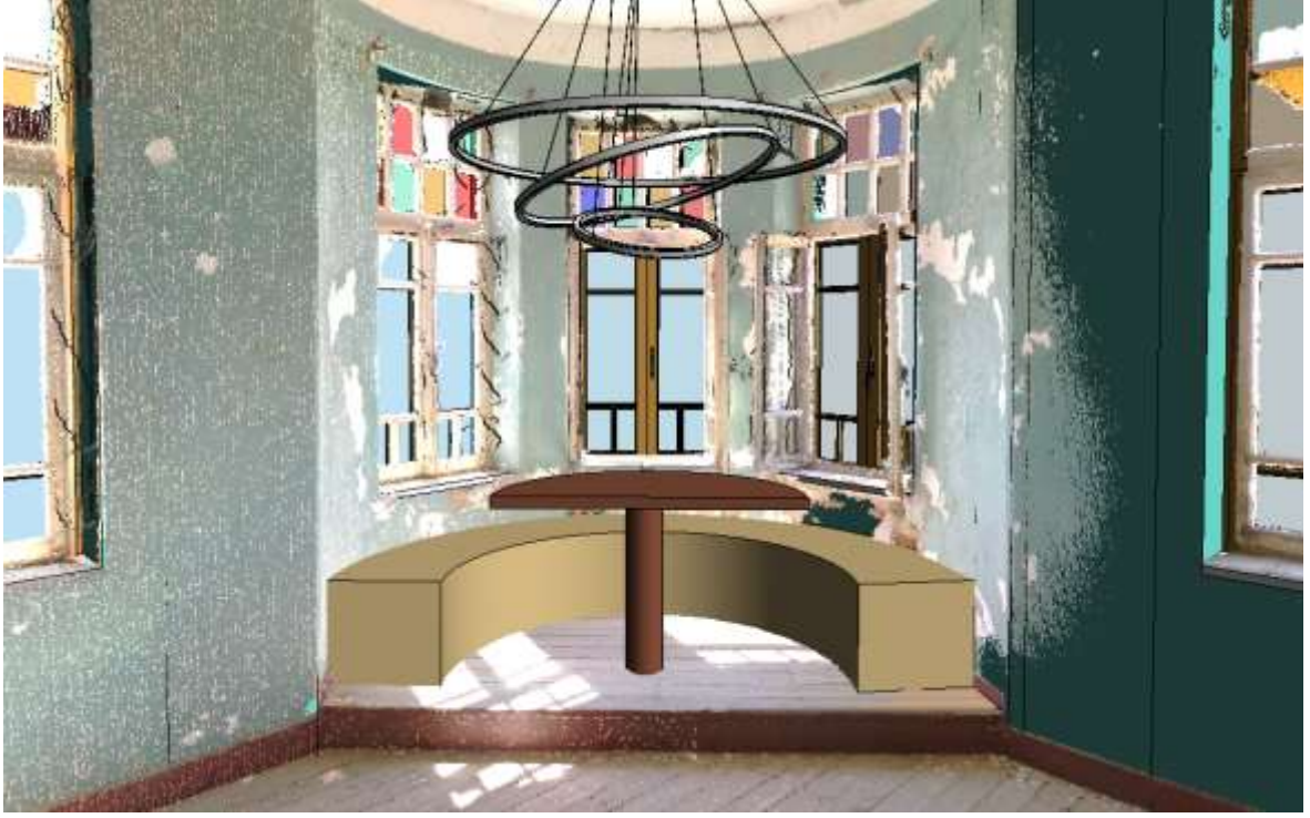
Şekil 8.4. Mehmet Ağa Konağı'nın yeniden işlevlendirme sonrası 3D nokta bulutu ve 3D HBIM modelinin çakıştırılmış görseli - Zemin kat oturma alanı
