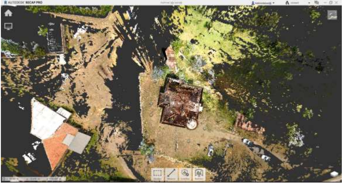
Şekil 5.30. ReCap programına aktarılan nokta bulutu - Vaziyet planı
