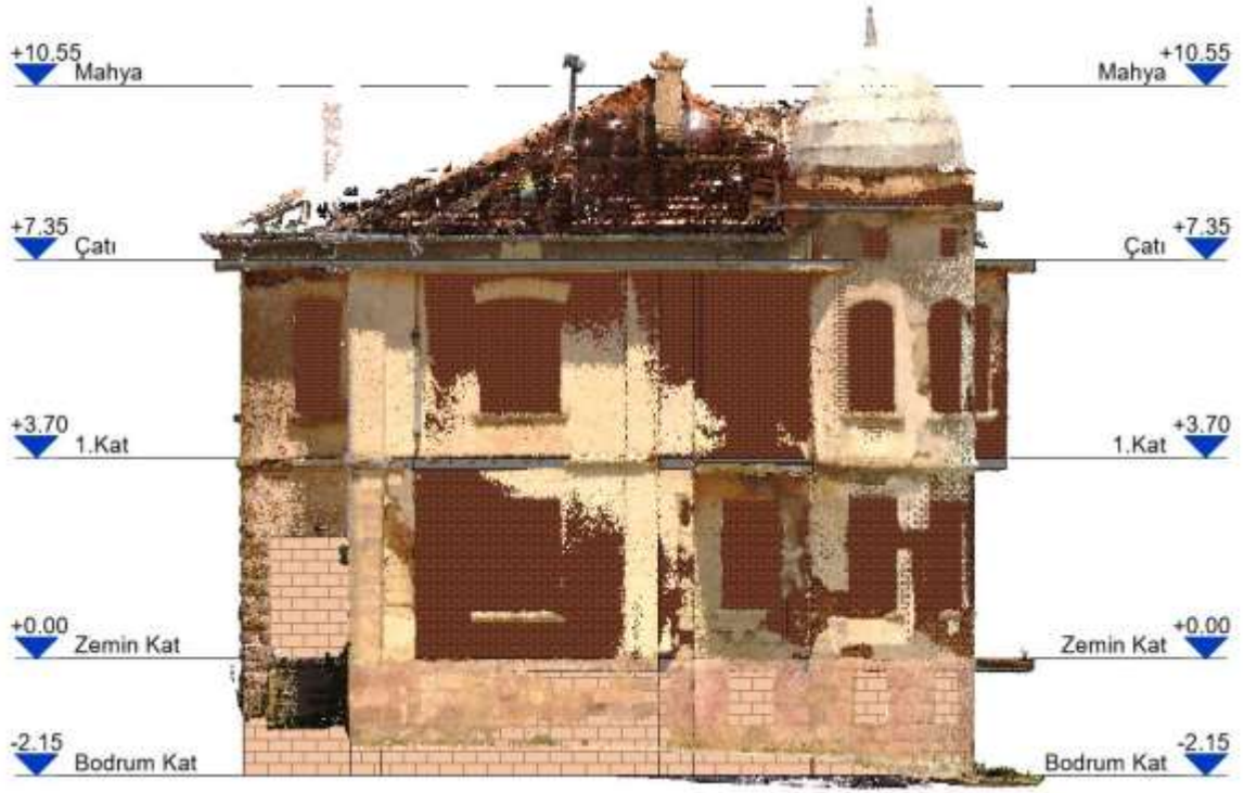
Şekil 7.23. Yapısal elemanları modellenen konağın, nokta bulutu ile çakıştırılmış görseli - Güney cephe
