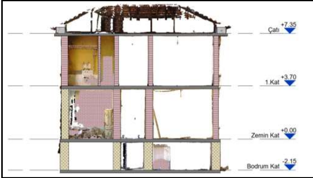
Şekil 7.14. Döşeme kalınlıklarının, kesit aracılığıyla belirlenmesi
