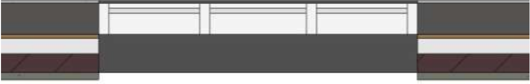
Şekil 8.2. Revit programında katmanların kesilmesi sorunu
