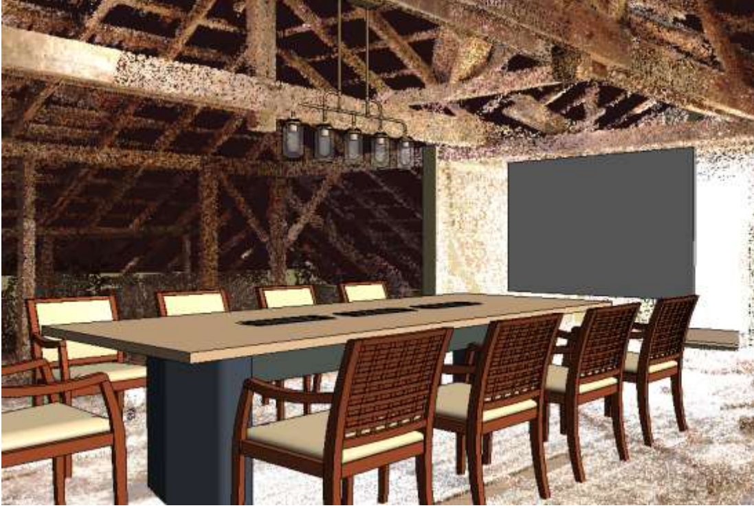
Şekil 8.6. Mehmet Ağa Konağı'nın yeniden işlevlendirme sonrası 3D nokta bulutu ve 3D HBIM modelinin çakıştırılmış görseli - Çatı katı toplantı alanı
