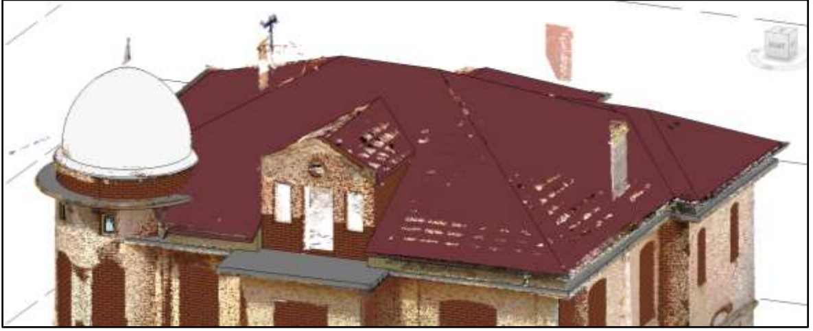
Şekil 7.39. Çatılar oluşturulduktan sonra nokta bulutu ile çakıştırılmış hali - Perspektif Görünüş
