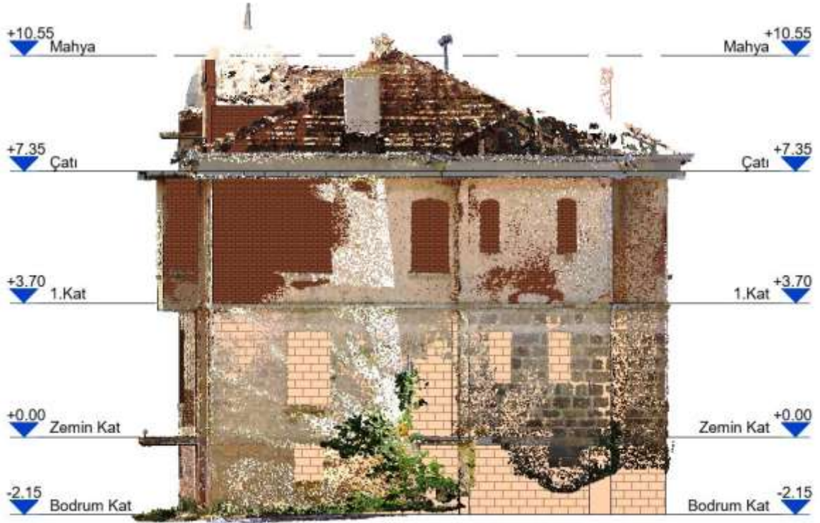
Şekil 7.21. Yapısal elemanları modellenen konağın, nokta bulutu ile çakıştırılmış görseli - Kuzey cephe
