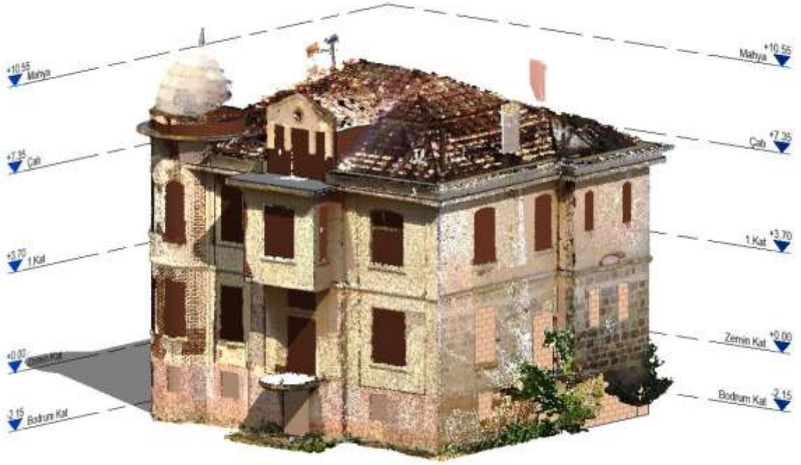
Şekil 7.25. Yapısal elemanları modellenen konağın, nokta bulutu ile çakıştırılmış 3B görseli - Kuzeydoğu perspektif görünüş
