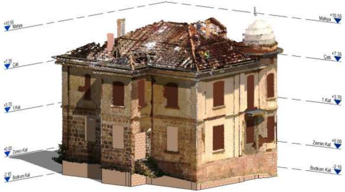
Şekil 7.27. Yapısal elemanları modellenen konağın, nokta bulutu ile çakıştırılmış 3B görseli - Güneybatı perspektif görünüş
